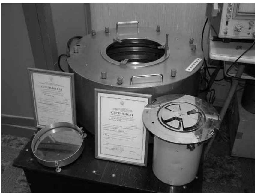
Рис. 2. Средство поверки КНЭП-1 и преобразователь измерительный «Поле-2», подготовленный к поверке.
