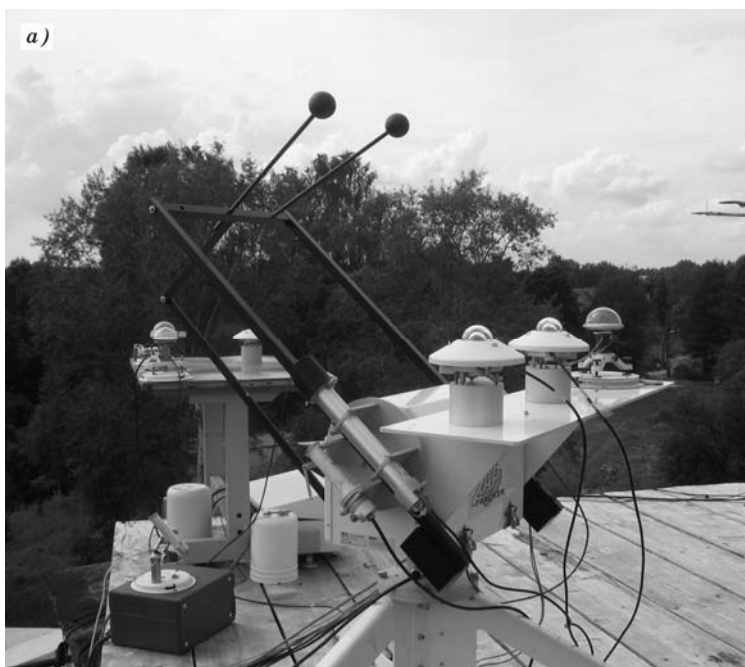
Рис. 1. Размещение актинометрического комплекса фирмы Kipp&Zonen a) на заднем плане на горизонтальном столе стоят незатеняемые пиранометры актинометры СН1 и М-3, один незатеняемый пиранометр СМ21 и затеняемые черсомеры на мачте:
