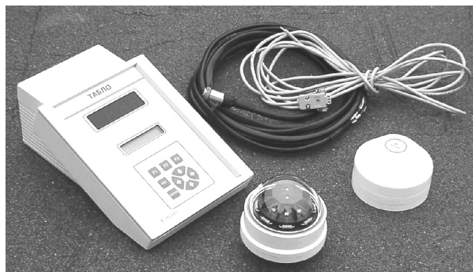
Рис. 6. Прибор для автоматизированных измерений продолжительности солнечного сияния «Пеленг ВК-05» с электронным измерительным блоком.
