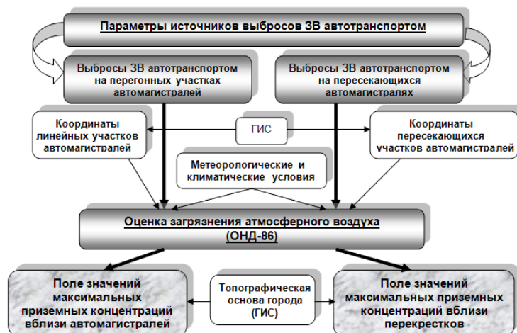
Рис.7 Схема проведения оценки загрязнения атмосферного воздуха вблизи автомагистралей и перекрестков с использованием ГИС
