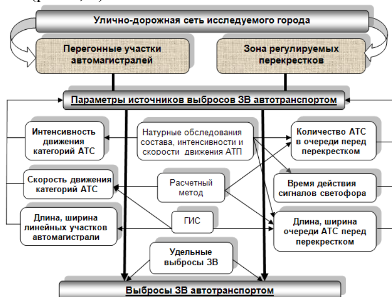
Рис.6 Блок-схема расчета максимальных выбросов загрязняющих веществ автотранспорта с использованием ГИС
