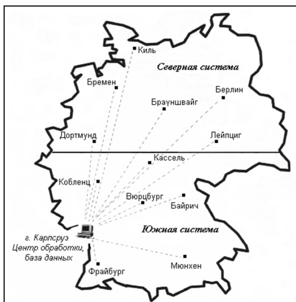
Рисунок 2.1 – Карта-схема расположения сенсоров молнии LPATS и IMPACT в Германии
